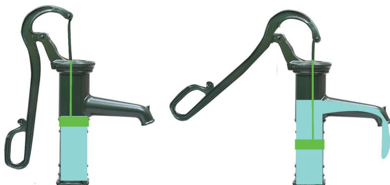
Les pompes de la rue Barat et de la rue des Clos sont équipées d'un balancier actionné à la main pour aspirer et libérer l'eau retenue par un clapet.
